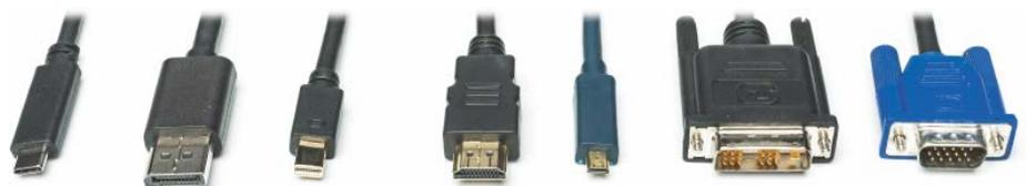
**Moderne Monitore schließt man per USB-C, DisplayPort oder HDMI an. DVI stirbt aus, einige Displays besitzen noch analoge VGA-Anschlüsse (von links: USB-C, DP, Mini-DP, HDMI, Mini-HDMI, DVI, VGA).**
