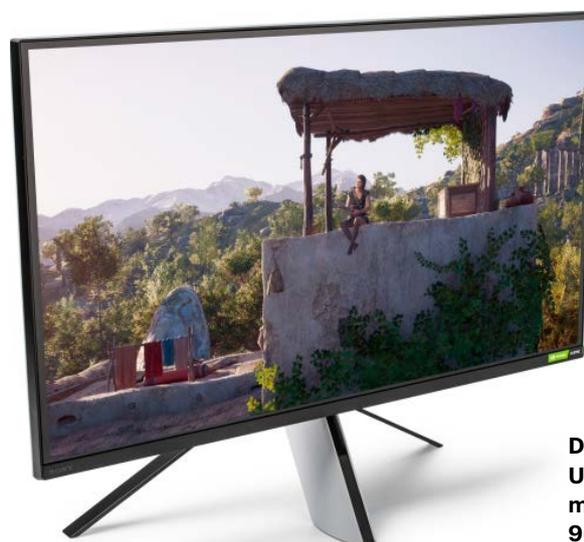
**Der 4K-Monitor Sony Inzone U27M90 erzielt starke Kontraste mit einem LED-Backlight aus 96 separat dimmbaren Zonen.**
