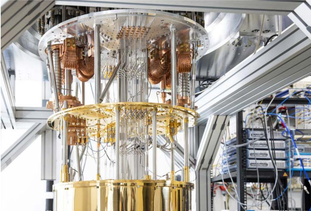
**Der kryogenische Aufbau kühlt das Herzstück eines supraleitenden Quantencomputers am Forschungszentrum Jülich. Im Projekt QSolid sollen Computer mit mehreren Quantenprozessoren und reduzierter Fehlerrate entstehen.**
