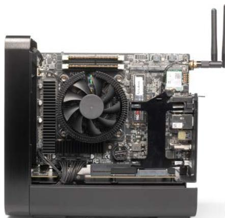
**Die linke Gehäusenhälfte des Magnus One ist allein für die Grafikkarte reserviert. Rechts sitzen unter anderem das Mainboard mit CPU-Kühler und der Steckplatz für eine 2,5"-SSD.**
