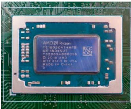
Bei der Vega-GPU im Notebook-Ryzen – hier eine ältere Embedded-Variante – dreht AMD jetzt bis Stufe 11 auf.
