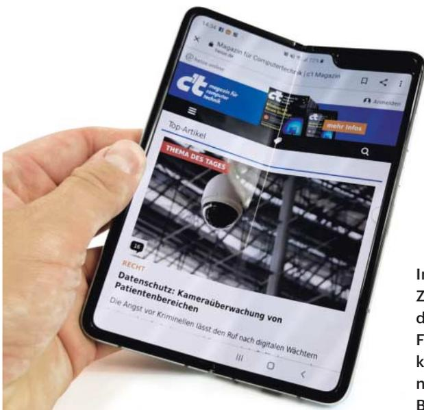
Im halb aufgeklappten Zustand erkennt man die Falz des Galaxy Fold 5G deutlich, komplett aufgeklappt nur aus bestimmten Blickwinkeln.
