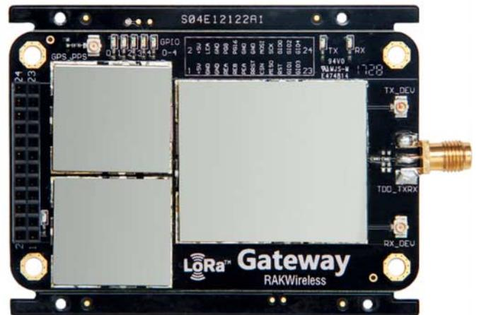
Per SMA-Anschluss lässt sich das RAK831 beispielsweise mit einer Dachantenne verbinden, um die Reichweite zu erhöhen.
