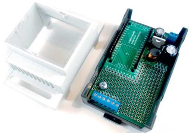
Zihatec ArduiBox: So passt ein ESP-Projekt auf die Hutschiene.
