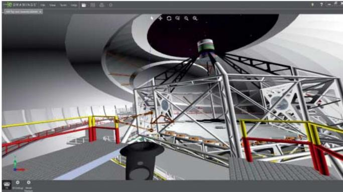
SolidWorks XR lässt Anwender per VR durch große Konstruktionen wie die des 10-m-Teleskops in Maunakea schweben.
