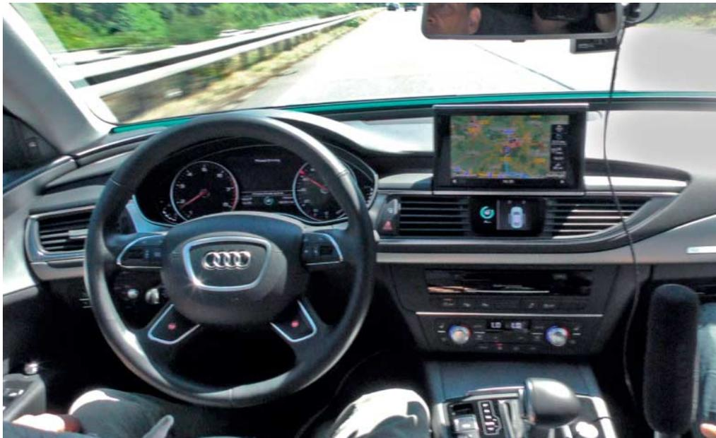
Im hochautomatisiert fahrenden Konzeptfahrzeug A7 Jack hat man 10 Sekunden Zeit, um die Kontrolle über das Fahrzeug vom Autopiloten zu übernehmen.
