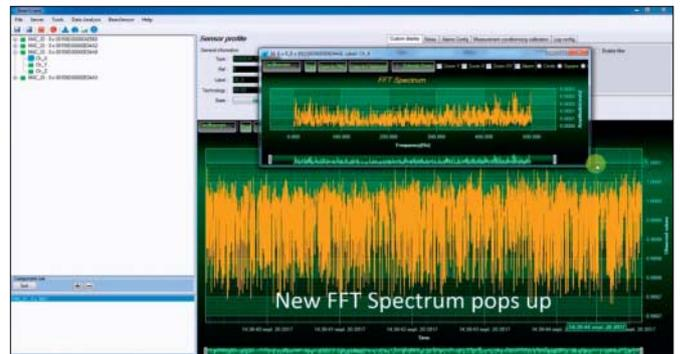
BeanScope transformiert Daten aus einem BeanAir-Sensornetz nachträglich oder neuerdings in Echtzeit von der Zeit- in die Frequenzdomäne.
