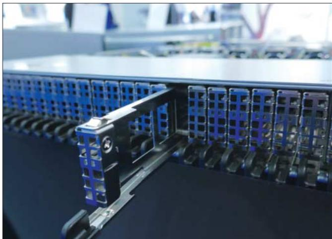
Über 36 Einschübe für SSDs im NGSFF-Format erreicht der AIC SB127-LX eine Speicherkapazität von bis zu 576 TByte auf 1HE.
