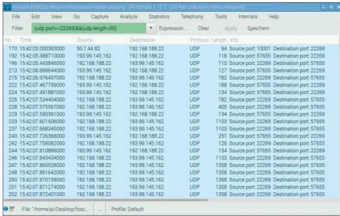
**UDP-Tunnel per Punchhole: Die App übernimmt für die UDP-Verbindung den Port, der zuvor von der Kamera für die Kommunikation mit dem Foscam-Server genutzt wurde.**
