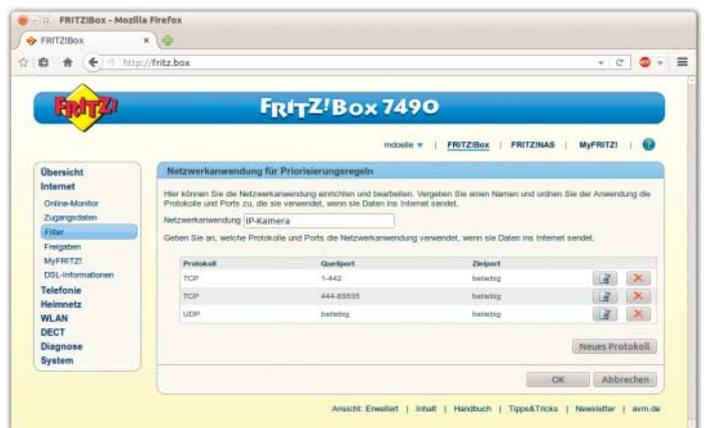
**Maulkorb für die Kamera: Sämtliche Ports mit Ausnahme des SSL-Webserver werden dem Kamera-Anwendungsprofil hinzugefügt und später mittels Kindersicherung blockiert.**
