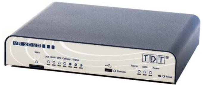
Der Multi-WAN-Router TDT VR2020 soll dank seines Metallgehäuses auch für den Einsatz in Industrieanlagen taugen. Die bindet er per Vectoring-VDSL, Gigabit-Ethernet und optional LTE-Mobilfunk ins Internet ein.
