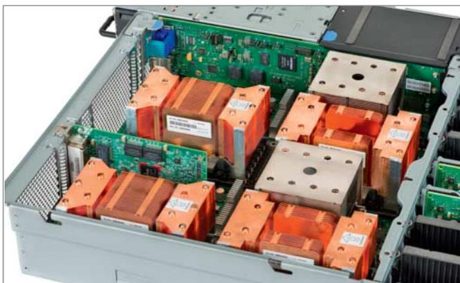
Das IBM-System S822LC kommt mit zwei Prozessoren und vier GPUs, die per NVLink miteinander verbunden sind.
