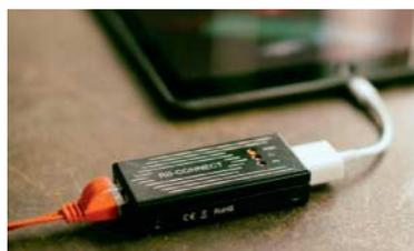
Der Ethernet-Adapter von Rebotnix kommt mit nur zwei Elementen aus – dem Controller-Kästchen und dem Lightning-USB-Kabel.
