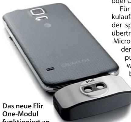
Das neue Flir One-Modul funktioniert an iOS und Android-Smartphones und löst deutlich höher auf als der Vorgänger.
