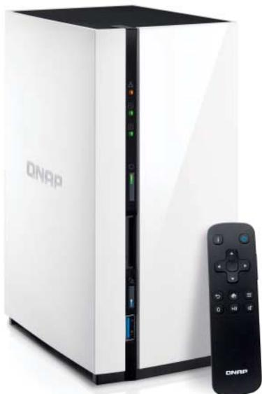
Die Wohnzimmer-NAS-Geräte QNAP TAS-x68 arbeiten mit zwei Betriebssystemen parallel: QTS ist für die Datenlagerung zuständig, Android für die Unterhaltung.
