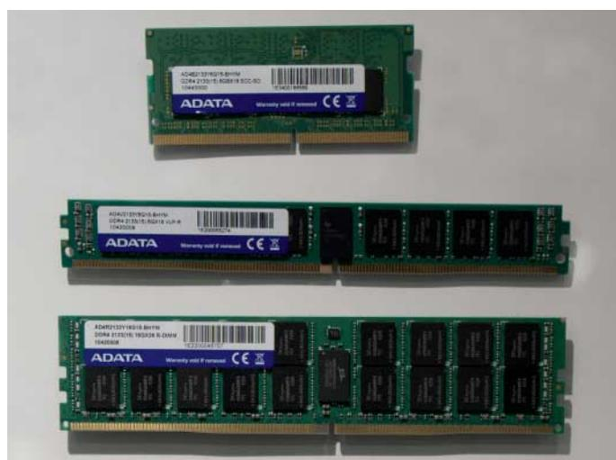
**Speicherhersteller haben DDR4-Module in unterschiedlichen Formaten fertig – auch schon als SO-DIMM.**
