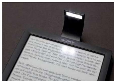
Eine LED in der Hülle dient dem Sony Reader als Leselampe. Die beleuchtet das Display aber lange nicht so gleichmäßig wie die ins Panel integrierten LEDs.
