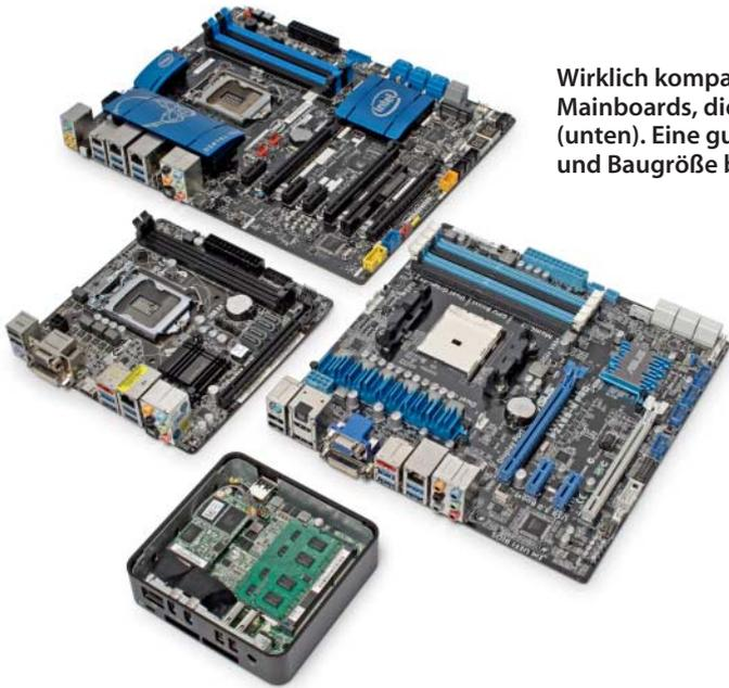
**Wirklich kompakte Rechner haben Spezial-Mainboards, die noch kleiner sind als Mini-ITX (unten). Eine gute Mischung aus Preis, Flexibilität und Baugröße bietet Micro-ATX (rechts).**
