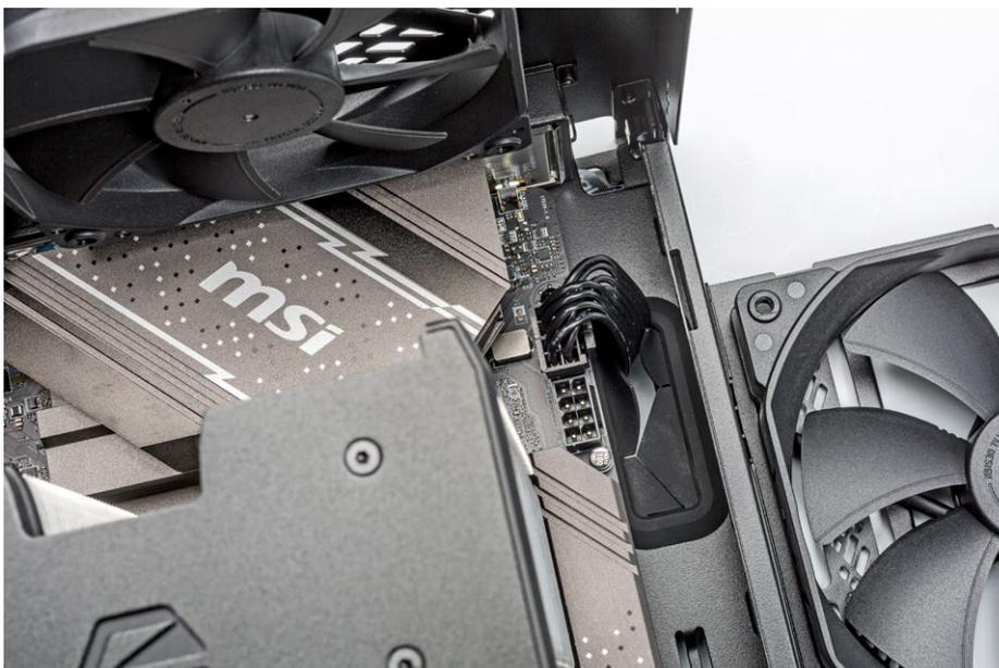
Der ATX12V-Stecker für die CPU-Stromversorgung wird oft vergessen. Ohne startet der Rechner nicht.
