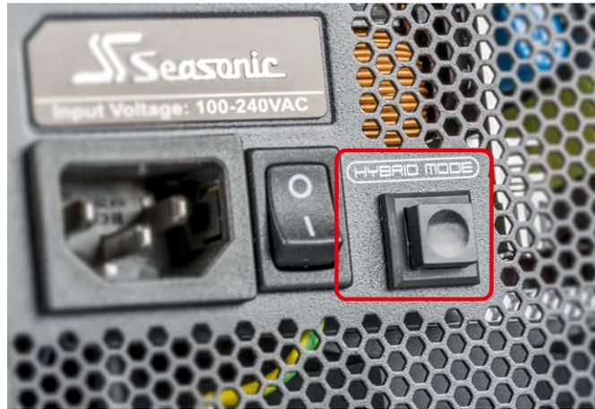
Lassen Sie den Hybrid-Mode-Schalter am Netzteil in der ausgeschalteten Position, damit der Lüfter erst bei höherer Last läuft.
