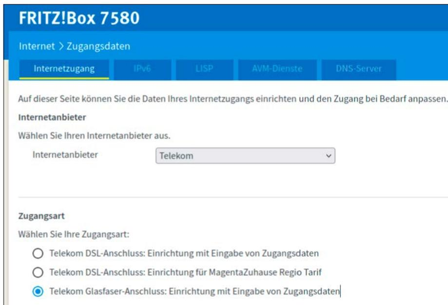
In den Einstellungen der Fritzbox 7580 ist der Betrieb an einem Glasfaseranschluss der Telekom bereits explizit vorgesehen.
