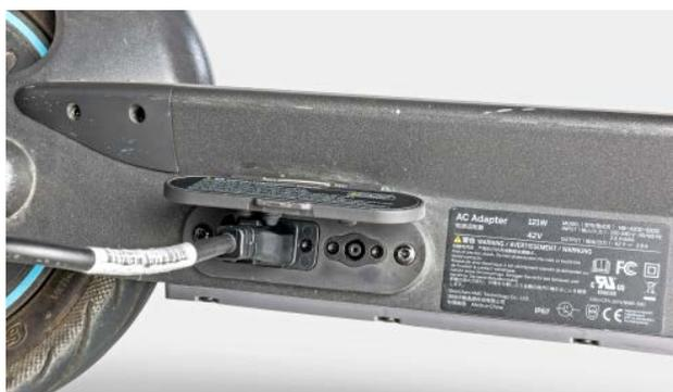
**Der Max G30D von Ninebot ist einer der wenigen E-Scooter mit eingebautem Ladegerät.**
