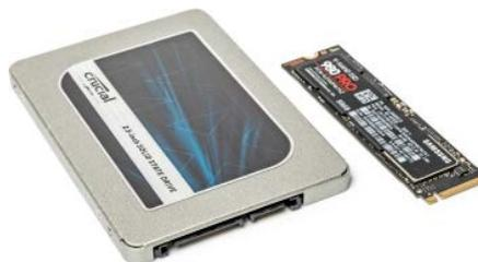
**Klassische SATA-SSDs im 2,5-Zoll-Gehäuse benötigen zwei Kabelstränge für Strom- und Datenanschluss, die modernen M.2-SSDs schraubt man meistens direkt aufs Mainboard.**
