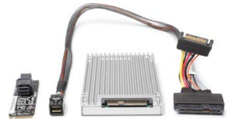
**U.2-SSDs sind häufig dicker als 2,5-Zoll-SATA-SSDs. Zum Anschluss an ein Desktop-Mainboard braucht man ein spezielles Kabel sowie meistens einen Adapter für den M.2-Slot.**
