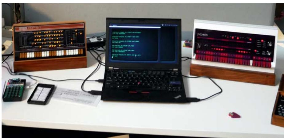
Auf Basis des Raspberry Pi lassen sich etliche Modelle alter Rechner bauen, hier eine PDP-8 im Kleinformat
