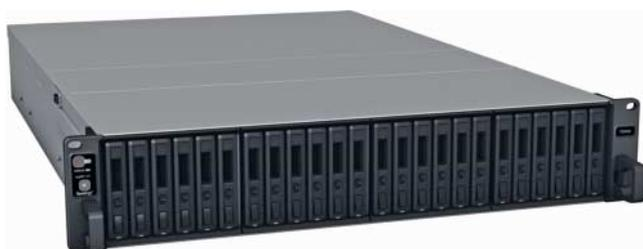
Die Flashstation 3400 beherbergt bis zu 24 2,5-Zoll-Festplatten für bis zu 184 TByte Speicherkapazität.
