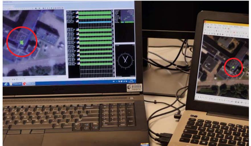
Der zusätzliche Empfang von Galileo-Satelliten (rechts) verkleinert die Punktwolke errechneter Positionen.
