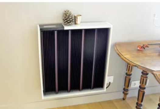
Die französische Firma Qarnot Computing wählt einen anderen Weg, weil sich Daten leichter übertragen lassen: Qarnot installiert Compute-Knoten mit lautloser Passivkühlung in privaten Haushalten, Schulen und Firmen. Die Q.rad-Systeme mit je vier Recheneinheiten sehen aus wie elektrische Heizkörper und setzen bis zu 500 Watt Leistung um.
