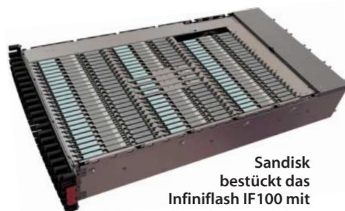
**Sandisk bestückt das Infiniflash IF100 mit 70 speziellen Flash-Modulen.**
