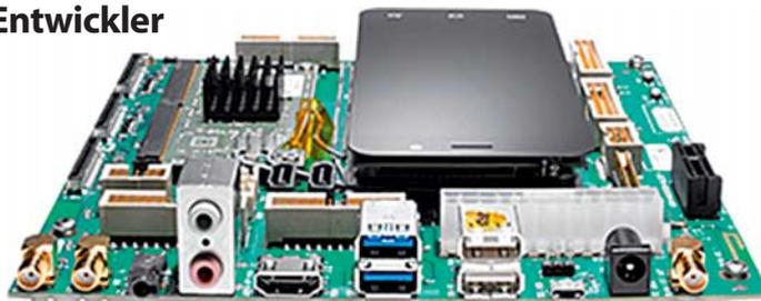
**Das DragonBoard 810 bietet vollen Zugriff auf die Technik eines High-End-Smartphones. Was wie ein solches aussieht, ist das aufgesteckte, optionale Display-Modul.**
