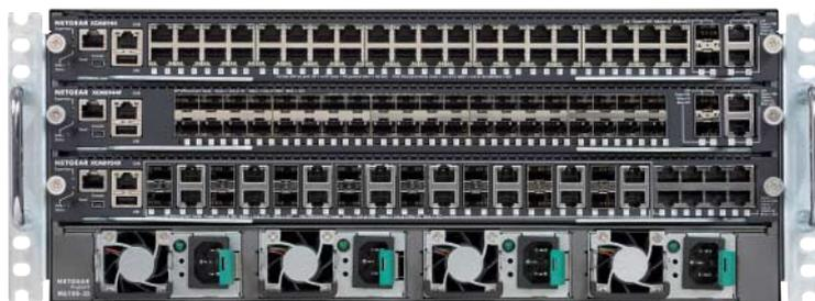
Netgears Switch-Chassis M6100 ist modular bestückbar und fasst maximal 144 Gigabit-Ethernet-Ports.
