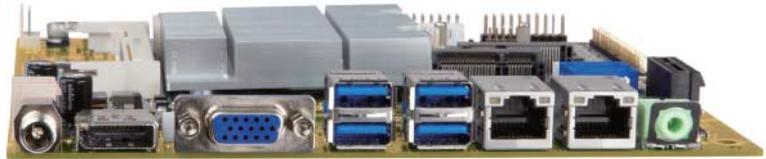
Strom-, aber vollem Mini-ITX-Platzbudget beglücken: Es hat ebenfalls eine quadratische Grundfläche mit nur 17 Zentimetern Kantenlänge, aber ein ATX-Anschlussfeld voller Bauhöhe. Somit passen ein paar mehr Buchsen (je 2 x RS-232, 2 x PS/2 und analog Audio) auf das Board. Die übrige Ausstattung ähnelt der des tKINO-BW. Allerdings gibt es beim MI808 einen DVI- anstelle des DisplayPort, optional einen CFast- statt
