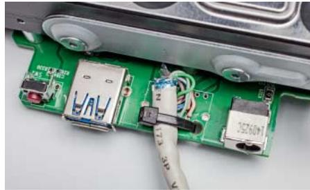
**Mit einem stramm gezogenen Kabelbinder lässt sich das Kabelende an der Platine sichern.**
