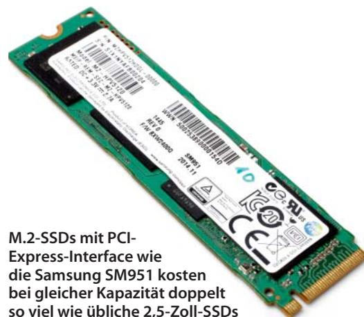
**M.2-SSDs mit PCI-Express-Interface wie die Samsung SM951 kosten bei gleicher Kapazität doppelt so viel wie übliche 2,5-Zoll-SSDs mit SATA-6G-Anschluss.**
