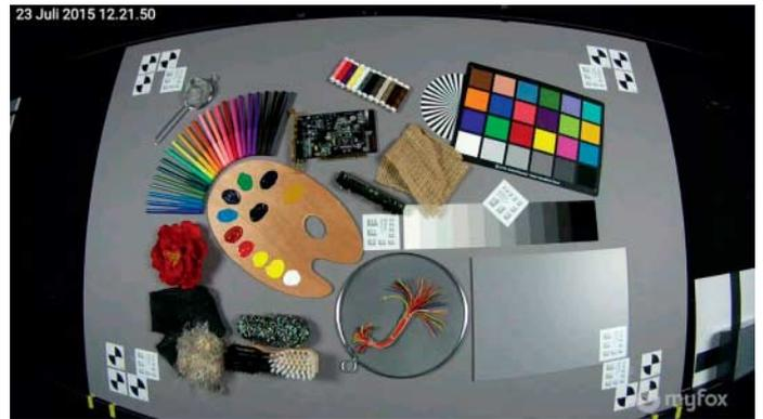
Die MyFox Security Cam gehört zu den Kameras des Feldes, die bei Tageslicht die besten Bilder produzieren. Auffällig ist aber auch bei ihr, wie stark das Bild verzerrt ist.
