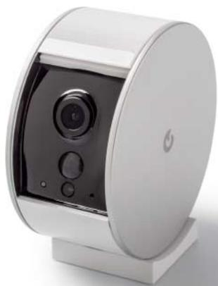
**Überträgt die MyFox Security Camera gerade das Live-Bild, so ist dies am Gerät durch eine grün blinkende LED zu erkennen. Andernfalls leuchtet das Lämpchen weiß.**
