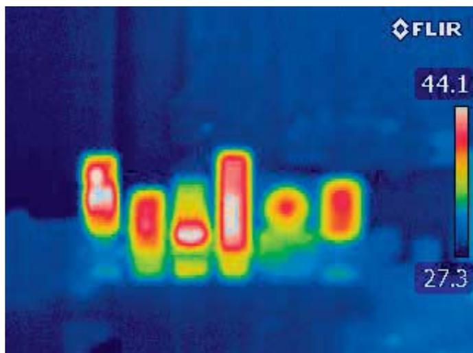
**Die Kameras im Wärmebild (von links: SpotCam, MyFox, Philips, Netatmo, Oco und Axis). Die Welcome wurde spürbar warm. Laut Netatmo ist dies aber normal und sicher. Ihr Aluminium-Gehäuse wirke als Kühlkörper und leite die Wärme aus der Kamera.**
