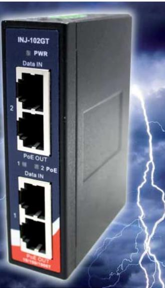
Der Power-over-Ethernet-Injektor INJ-102GT von Aceeed soll in Schaltschränken oder Verteilerkästen in Industrieanlagen arbeiten. Er liefert nach der PoE+-Spezifikation IEEE 802.3at maximal 30 Watt pro Port; die Variante GT++ stellt bis zu 45 Watt bereit. Jedes Modell gibt es wiederum in zwei Versionen für den Betrieb an 50 Volt oder 24–36 Volt Gleichspannung. Die Injektoren vertragen Betriebstemperaturen zwischen -25 °C und +70 °C. Je nach Typ kosten sie zwischen 76 und 200 Euro. (ea@ct.de)
