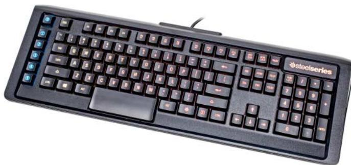
**Die RGB-Tastatur SteelSeries Apex M800 enthält robuste mechanische Schalter; die Farben aller Tasten lassen sich individuell anpassen – für Spiele oder Anwendungen, die man im Dunkeln bedient.**
