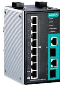
**Der Moxa EDS P510A-8PoE-Switch arbeitet auch unter rauen Bedingungen, etwa in Außenbereichen oder in explosionsgefährdeten Industrieanlagen.**
