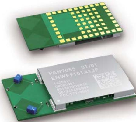
die Funktechnik als Modul zukaufen. Das PAN9055 von Panasonic bringt alles mit, was man zum Funken per WLAN (802.11n) und Bluetooth 4.0 braucht – von zwei Keramik-Antennen über den Controller bis hin zum Software-Stack.
