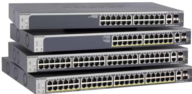
Die Switches der S3300-Reihe von Netgear besitzen je zwei gleichzeitig nutzbare 10GBase-T-Ethernet- und SFP+-Anschlüsse, um bis zu sechs Geräte zu koppeln.
