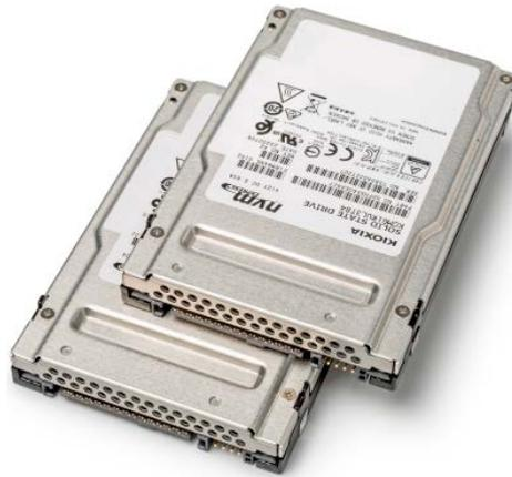
**Viele SSDs für Server haben Hotswap-taugliche Bauformen wie U.3: Das entspricht dem „dicken“ 2,5-Zoll-Format mit 15 Millimetern Bauhöhe und einem SFF-8639-Stecker, der PCI Express und alternativ SATA oder SAS überträgt.**
