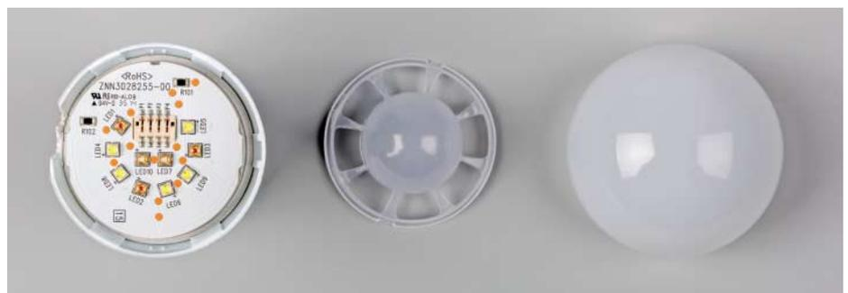
In der farbigen LED-Lampe sitzen blaue LED-Chips mit gelbem Phosphor, LEDs mit rotem Phosphor für das wärmere Licht und rein blaue LEDs. Die innere Diffusorkappe mischt das Licht der farbigen LEDs zusammen, die diffuse Lampenhülle verteilt das gesamte Licht gleichmäßig im Raum.
