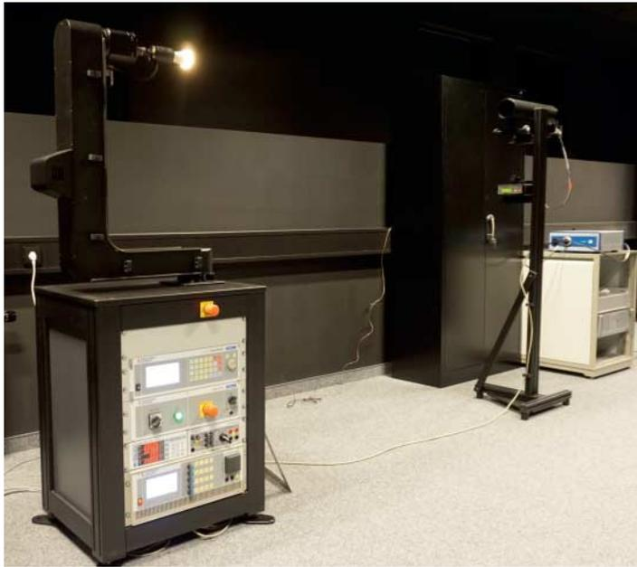
Das Licht der Retrofit-Lampen wurde mit dem Gonio-photometer LGS 650 von Instrument Systems von einem knapp 2,50 Meter entfernten aufgestellten Spektroradiometer erfasst.
