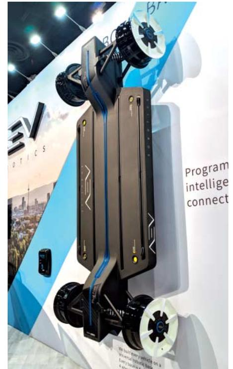
Die Antriebstechnik des autonomen Fahrzeugs von AEV steckt wie beim Mercedes Urbanetic in der Bodenplattform. Modulare Chassis erlauben unterschiedliche Fahrzeugtypen und Einsatzzwecke.
