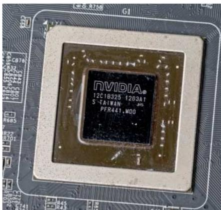
Entfernt man den Kühlkörper, stößt man auf eine GPU, die so gar nicht wie das Original links aussieht. Damit der Betrug nicht zu offensichtlich wird, haben die Fälscher die Chip-Kennung bei der manipulierten GPU rechts abgeschliffen.
