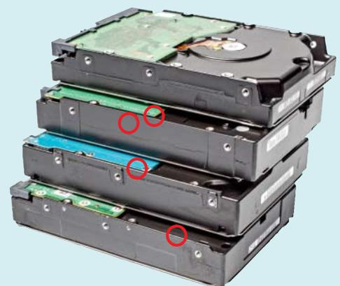
Manchen Platten mit besonders hoher Kapazität fehlen einige Befestigungslöcher; sie lassen sich deshalb nicht in jedem Gehäuse oder Wechselrahmen festschrauben.
