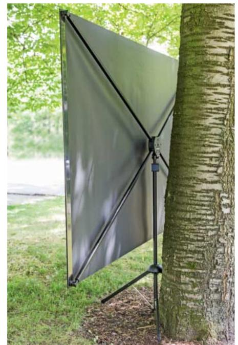
Kleine Federn am Ende der Vierkantrohre spannen das Projektionstuch auf; zusätzlich sicherten wir die Leinwand mit Schnüren gegen Wind.
