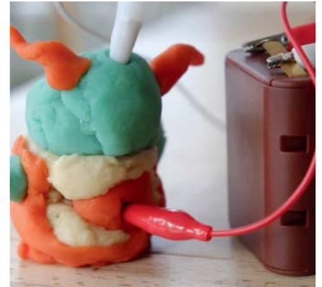
Verbinden Sie den Kontakt im Rücken mit dem Pluspol und die „Kopfhaut“ mit dem Minuspol der Batterie.
