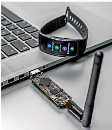
Eigentlich ist der Ubertooth-USB-Stick eine Open-Source-Entwicklungsplattform für Bluetooth-Geräte, die mit Bluetooth-Funk auf dem 2,4-GHz-Frequenzband kommunizieren. Das sind beispielsweise Fitnesstracker, aber auch Smartwatches, Bluetooth-Schlösser und Tastaturen.
