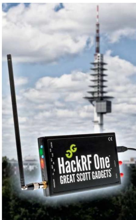
**Das HackRF One kann nahezu beliebige Funksignale senden und empfangen. Damit können Pentester Smarthome-Alarmanlagen außer Gefecht setzen, Autos öffnen und SMS abfangen. Sogar Telefongespräche lassen sich abzapfen – oder man hört damit schlicht Radio.**
