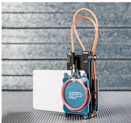
Der Proxmark3 ist der De-facto-Standard für jeden, der sich tiefergehend mit NFC, Smartcards, RFID-Tags & Co. beschäftigt. Das Hardware-Design und die Software stehen unter einer Open-Source-Lizenz, er ist von mehreren Herstellern in unterschiedlichen Varianten erhältlich. Unsere Ausführung hat zwei Antennen, einen micro-USB Anschluss und einen optionalen Akku-Steckplatz für den autonomen Betrieb. Unterstützt werden eine Vielzahl von RFID-Standards auf 125-kHz-, 134-kHz- und 13,56-Mhz-Basis.
