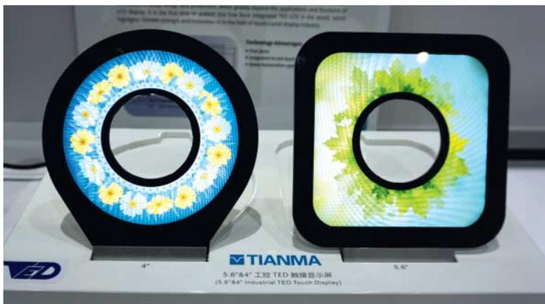
Mit Freiform-LCDs wie hier von Tianma lassen sich interessante Cockpits gestalten. Legt man solche Displays um einen anderen Schirm, entsteht eine Art 3D-Darstellung.
