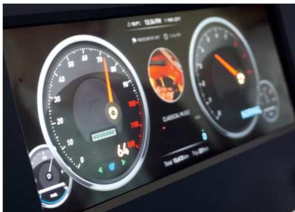
LG legt die Zeiger mit einem transparenten OLED über die LCD-Anzeige und erzeugt so einen 3D-Eindruck.
