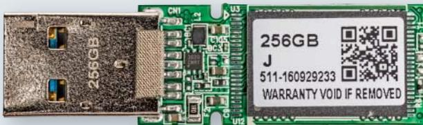
Xlyne benötigt für diesen 256-GByte-Stick lediglich zwei Speicherbausteine à 128 GByte. Controller und zweiter Flash-Baustein befinden sich auf der Rückseite.
