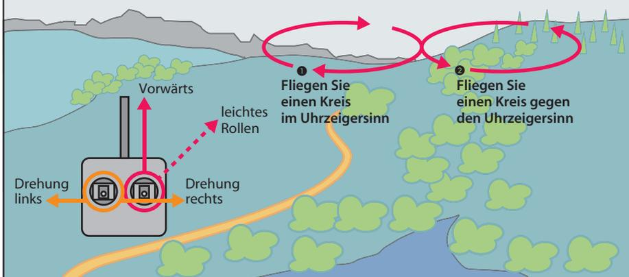
Beim Rollen der Drohne werden die Kreise enger, weil der Quadrocopter sich dann zusätzlich zur Änderung der Vorwärtsrichtung durch Gieren auch orthogonal in Richtung der Kreismitte bewegt.
