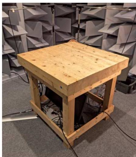
Die dicke Platte des Messtischs schwingt bei Vibrationen des Testgeräts nicht mit.
