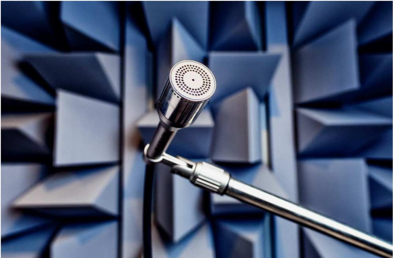
**Um das Rauschen von Lüftern, das Klackern von Festplattenzugriffen und andere Störgeräusche von Testgeräten zuverlässig und genau zu messen, ist hoher technischer Aufwand nötig: außer einem kalibrierbaren Messsystem etwa auch ein schalltoter Raum mit Kühlung.**
